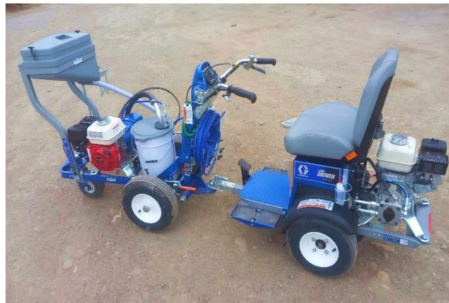
Слика бр.2 Машина за бележење хоризонтална сигнализација набавена од Општина Велес
