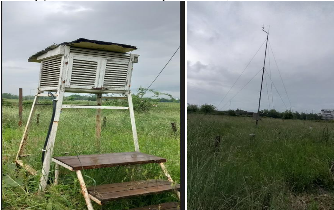
Слика: број 1 : Рачна и автоматска метеоролошка станица
