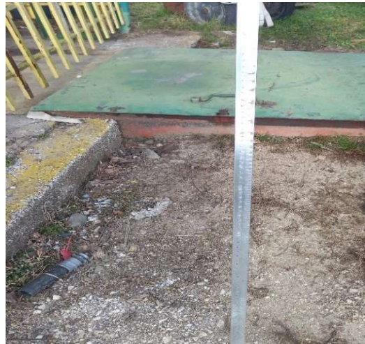
Слика број 2 – Мерна летва со која се мери примени количини на гориво во Подружница Скопје
